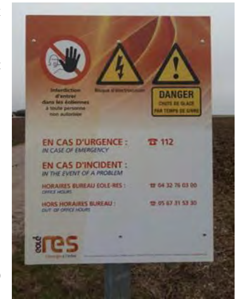
Figure 27 : Exemple de panneau d'affichage sur un parc éolien (Source : RES)
