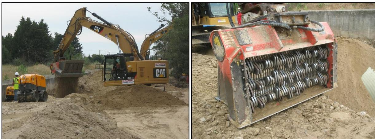
**Godet tamiseur monté sur une pelle-mécanique permettant de récupérer uniquement la terre végétale**
