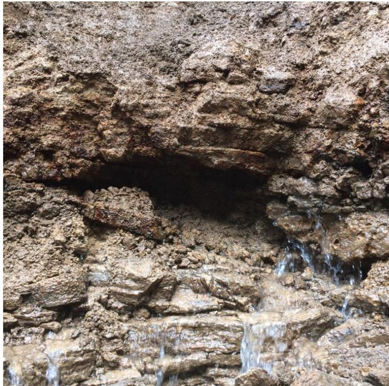
Venue d'eau au sein d'un niveau altéré-fissuré dans des formations trachytiques
