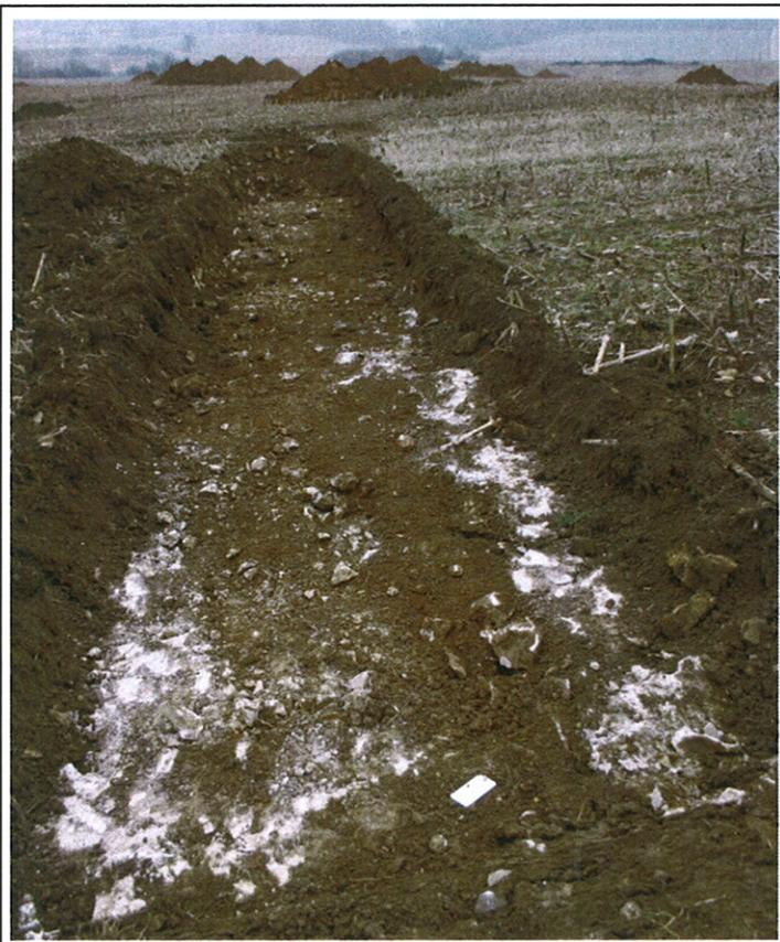
Fig. 3 : Vue de la faible profondeur de certains sondages : terre végétale sur dalle calcaire...
