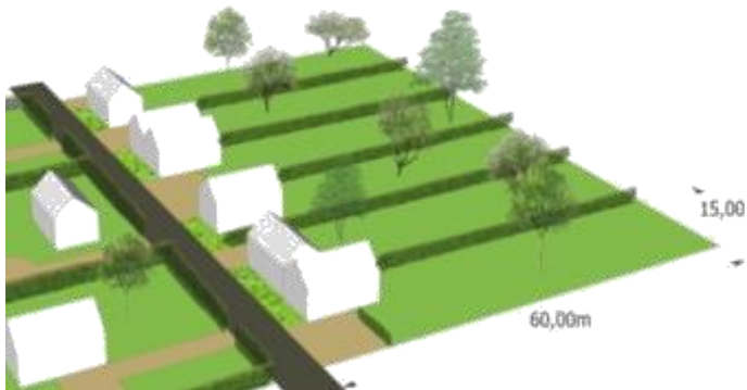
Gérer la densité urbaine (parcelles en lanières et dégagement des jardins à l'arrière)
